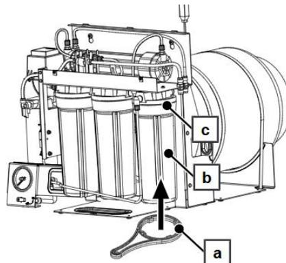
4. Drehen Sie den Behälterschlüssel im Uhrzeigersinn, um den Patronenbehälter zu öffnen.
